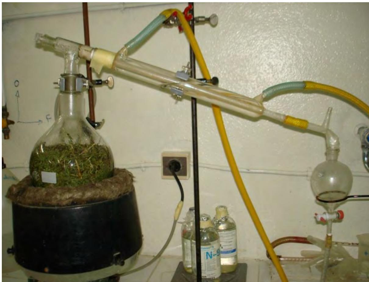
**Figure 12.** Montage d'hydrodistillation utilisé pour l'extraction des huiles essentielles
