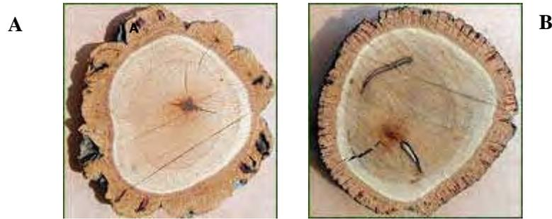
Figure15 -Types de liège (A = liège mâle; B = liège femelle)
