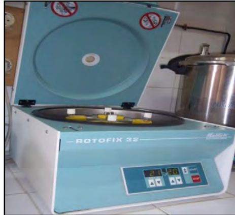
Figure N°16 : Centrifugeuse Hettich-Zentrifugen de type ROTOFIX 3.
