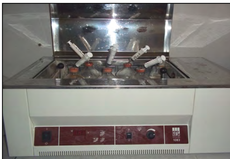
Figure N°15 : Bain marie MEMMERT de type GFL 1083 contenant les réacteurs de fermentation.
