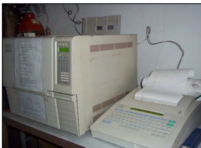
Figure N°18 : Chromatographe SCHIMADZU de type GC-17A combiné à une colonne capillaire de type DB-5 (0,25 mm D.I×30 m) et un détecteur FID .
