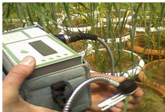
Photos. 05: Prise de mesures de la fluorescence avec un fluorimètre.
