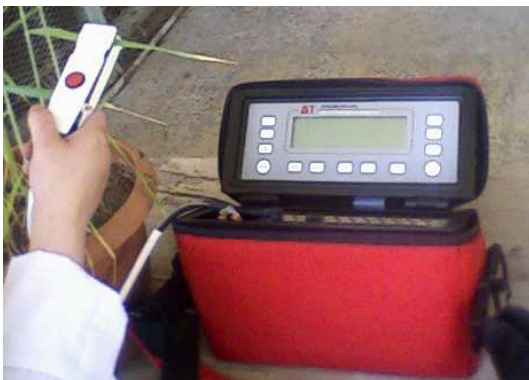
Photos. 03: Prise de mesures de la résistance stomatique à l'aide du Poromètre.
