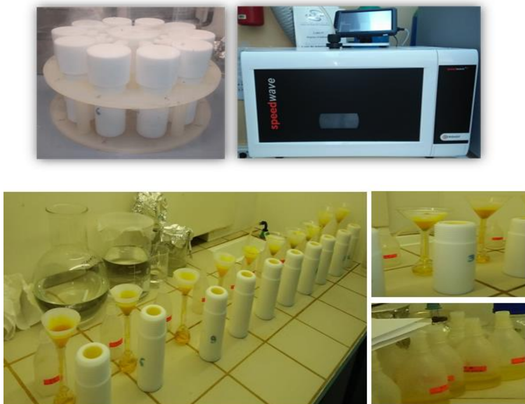
Figure 21. Bombes en téflon, four microonde et processus de filtration des échantillons et conservation des échantillons.
