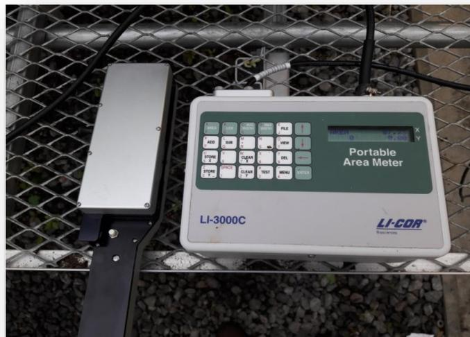
Image 4 : Analyseur de surface portable LI-3000C, LI-COR Biosciences.
