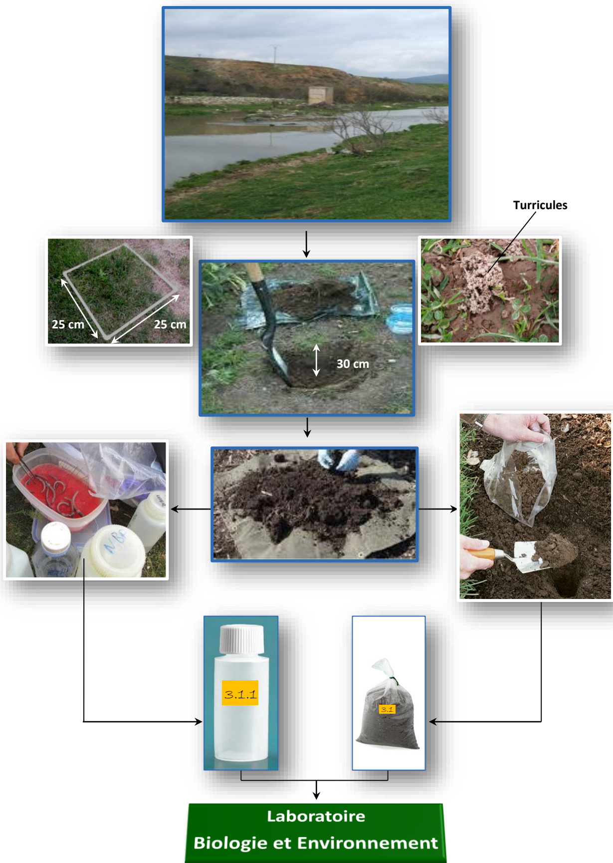
Figure 1 : Méthode de prélèvement in situ des sols et des vers de terre.
