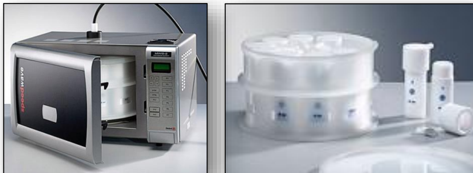
Figure 38 : Le four à microondes et les bombes en téflon utilisés dans l'extraction des ETMs.
