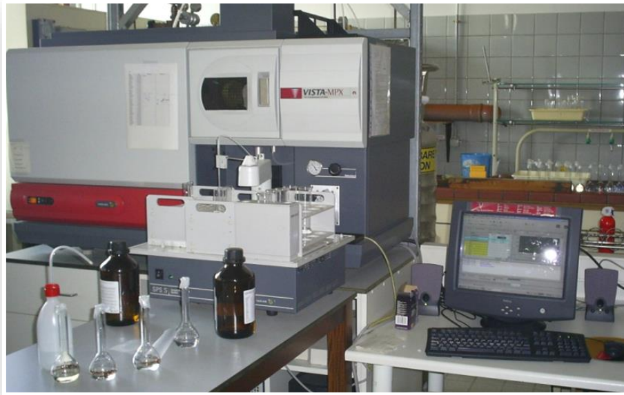
Figure 40 : Varian type Vista-MPX CCD Simultaneous (ICP-OES). (Laboratoire de Chimie Analytique et Ecochimie Appliquée, Belgique)
