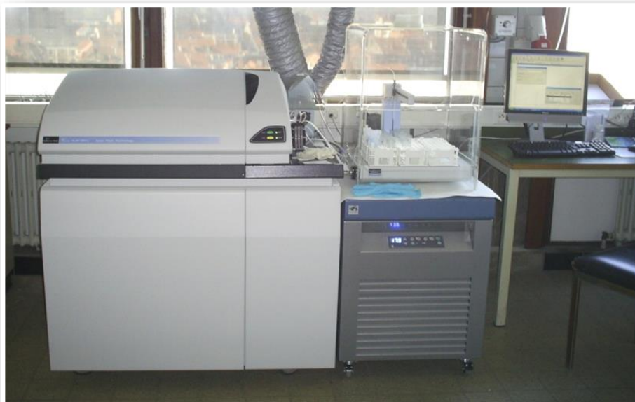
Figure 41 : Perkin Elmer type ELAN 9000 (ICP-MS). (Laboratoire de Chimie Analytique et Ecochimie Appliquée, Belgique)
