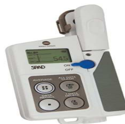
Figure 6. Chlorophylle-mètre minolta SPAD 502
