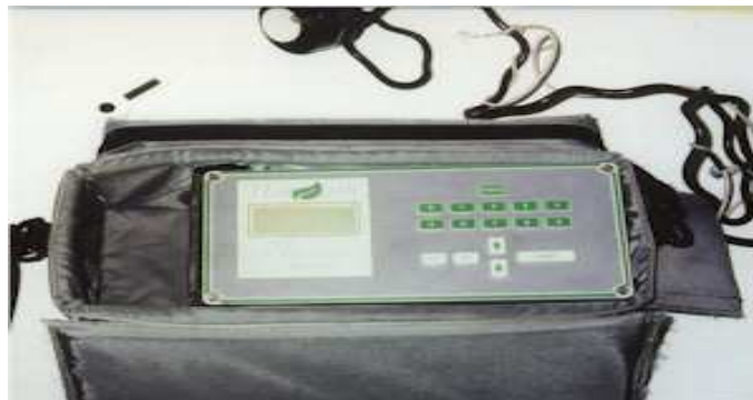
Figure 7. Fluoromètre de type monitoring system Hansatech
