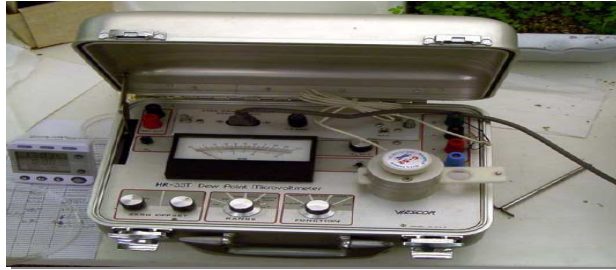
Figure 5. Type de psychromètre Wescor C-52 utilisé
