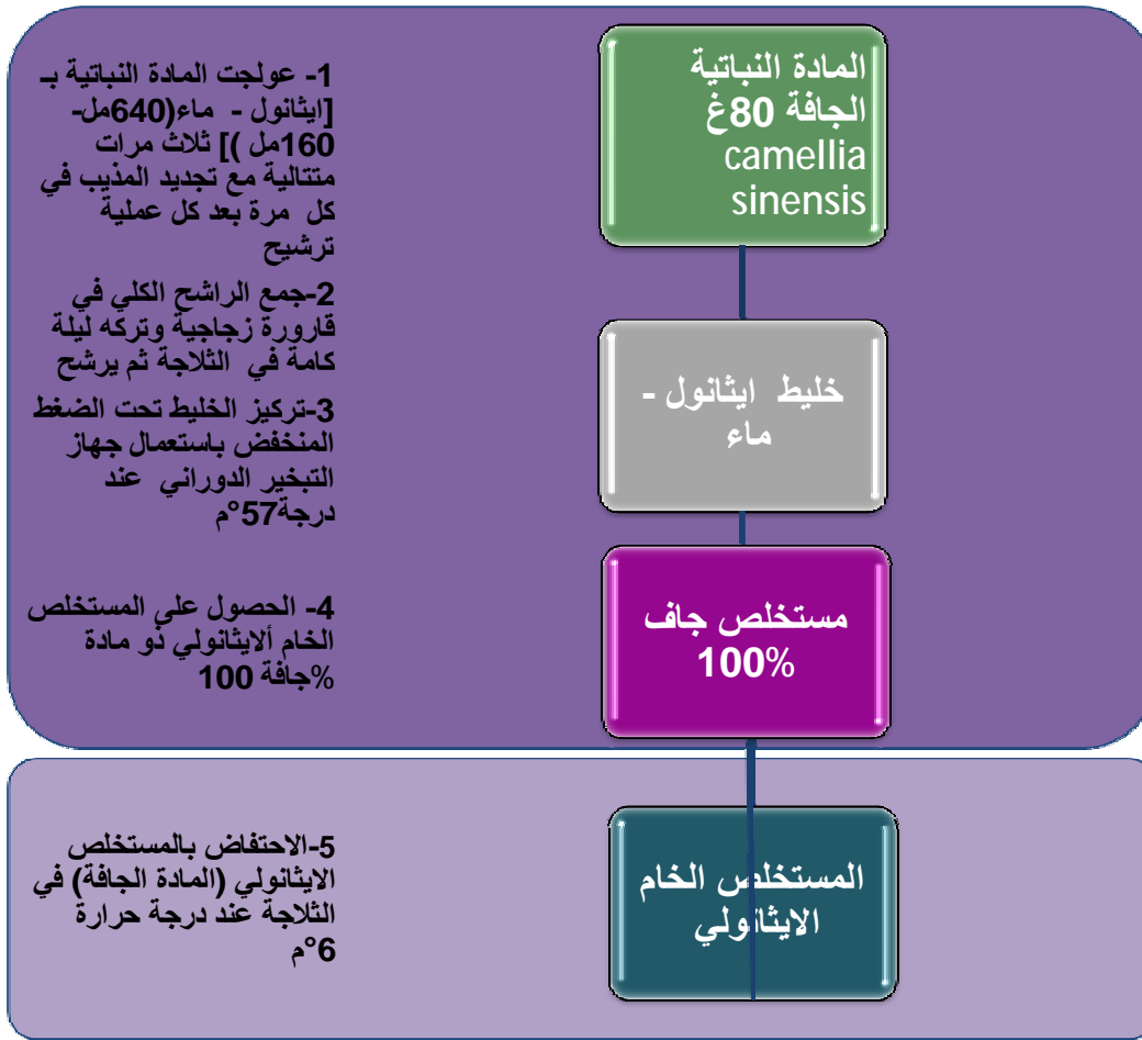
الشكل (15) : مراحل استخلاص المستخلص الخام الأيثانولي من نبتة الشاي الأخضر
