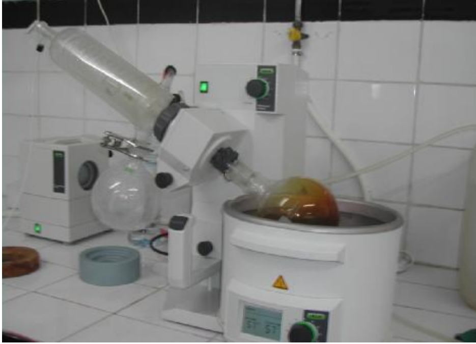
الشكل(12): جهاز التبخير الدوراني Rotavapeur
