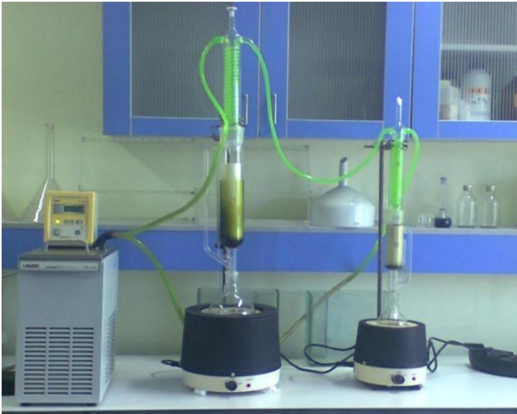
Figure 21 : Photographie représentant un dispositif reliant deux Soxhlet sur leurs chauffes ballons à un Cryothermostats à circulation.
