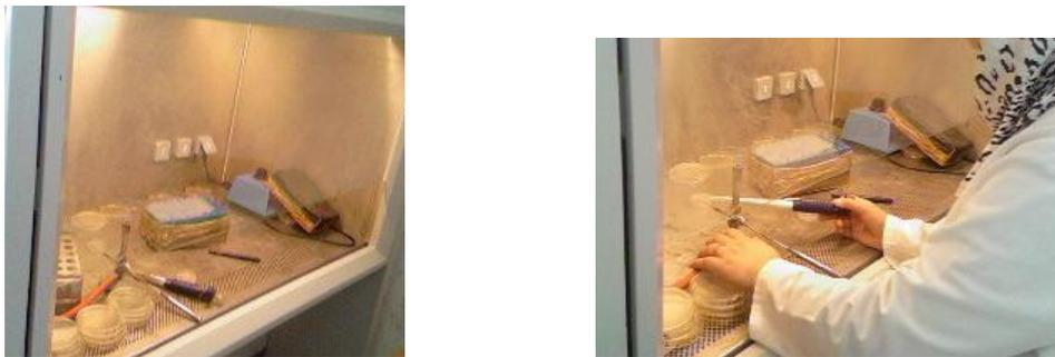
**Figure 17** - Hotte à flux laminaire
