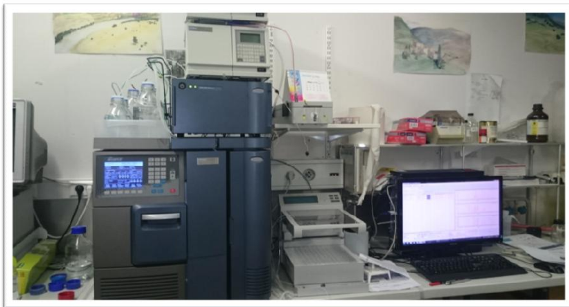
Figure 16. Chromatographie liquide à haute performance(HPLC) équipé d'un détecteur photodiodes (PDA) couplé à un collecteur (Fraction Collector III)
