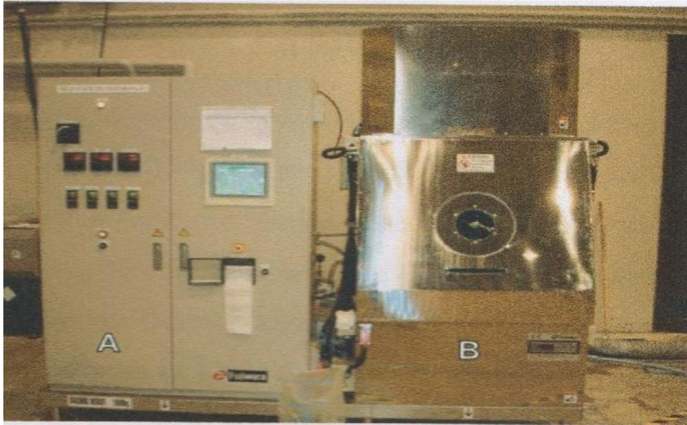
**Figure 21:** Le fermenteur Fujiwara : (A) armoire de contrôle, (B) fermenteur *Koji* avec sa cuve de culture à l'intérieur.
