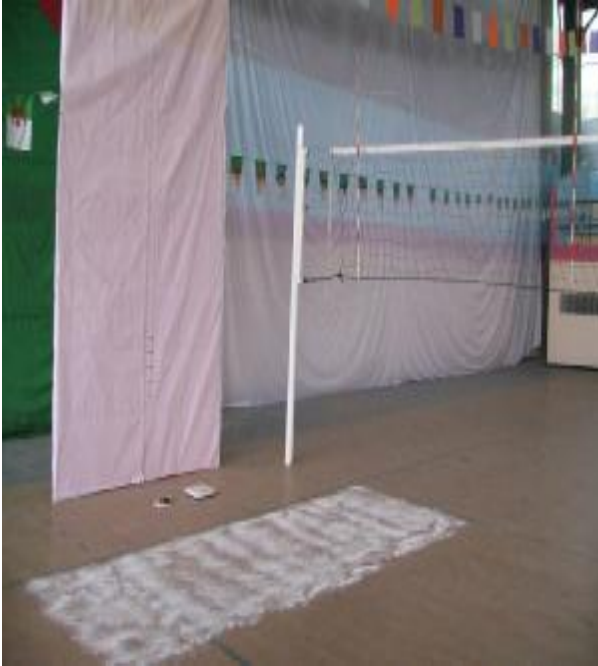
Figure n°9 : Représente les outils d'investigations (Planche millimétrée, décamètre filet avec les deux antennes, poudre blanche étalée sur le sol, un pèse personne)
