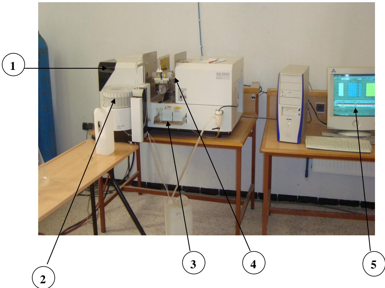
Photo 6 : Spectrophotomètre d'Absorption Atomique de type Shimadzu AA 6800.
