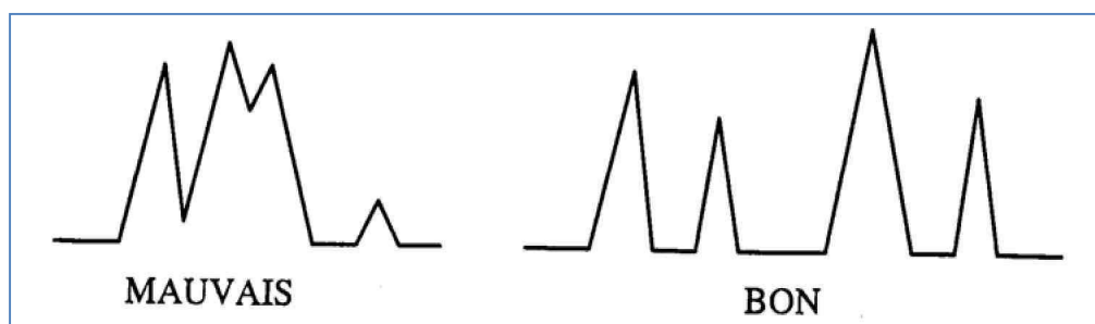
Figure n ° 5 : l'analyse qualitative d'un chromatogramme (Anonyme. a, 2006).
