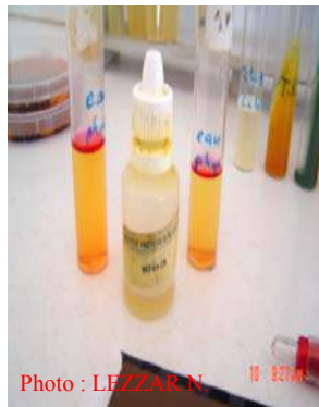
5. Milieu Urée-Indole avant et après addition du réactif Kovacs
