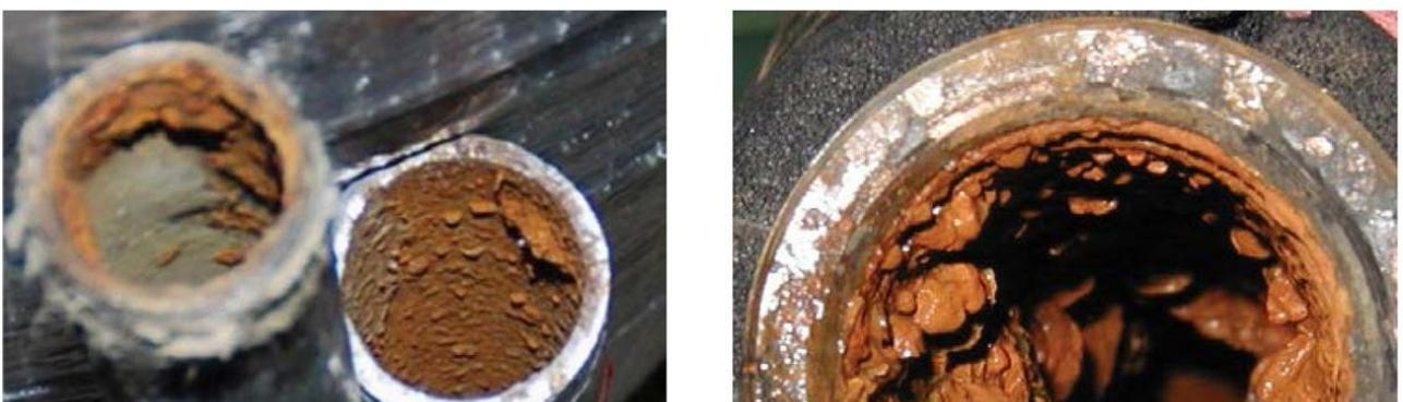
**Figure 4 :** Accumulation de biofilm au niveau de la canalisation
