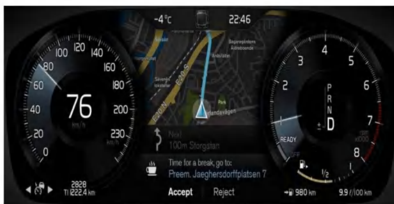
Figure 7. 1 : le système de détection de la fatigue de Volvo dans la voiture CX90
