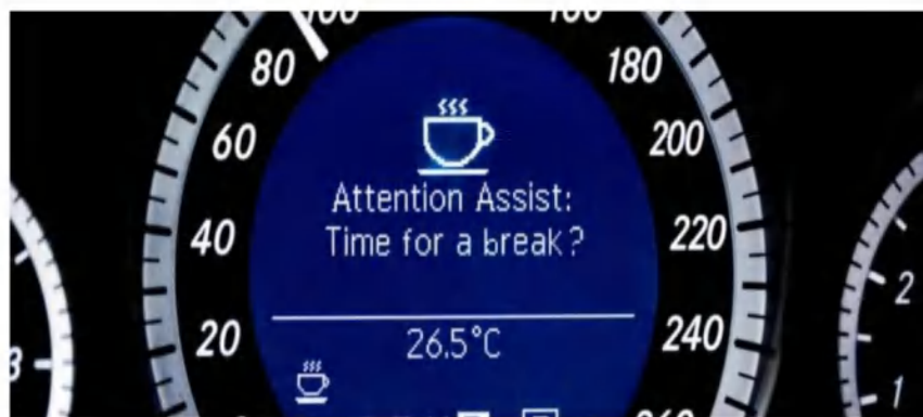
Figure 7. 2 : l'alerte du système de détection de la fatigue de Mercedes-Benz (attention assist) [302]
