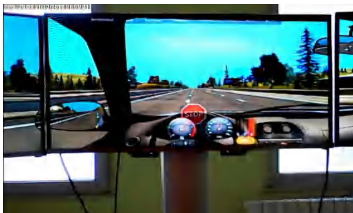
Figure 5. 3 : Cette figure montre les tailles et visibilité de la forme du signal d'arrêt qui a été choisie dans cette expérience parmi de nombreuses autres tailles fournies par ce simulateur pour tester le temps de perception-réaction [PRI].
