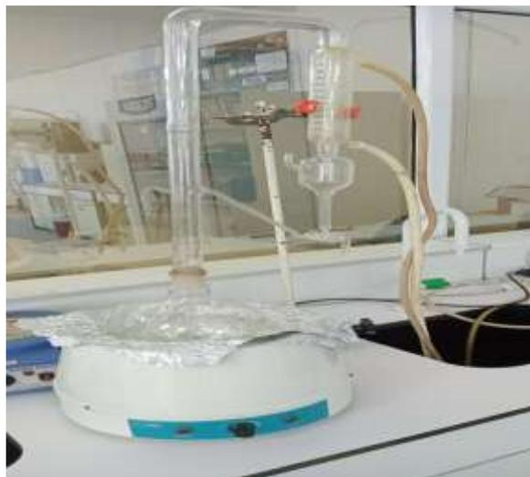
**Figure 32.** Hydrodistillateur de type Clevenger (Originale, 2021).
