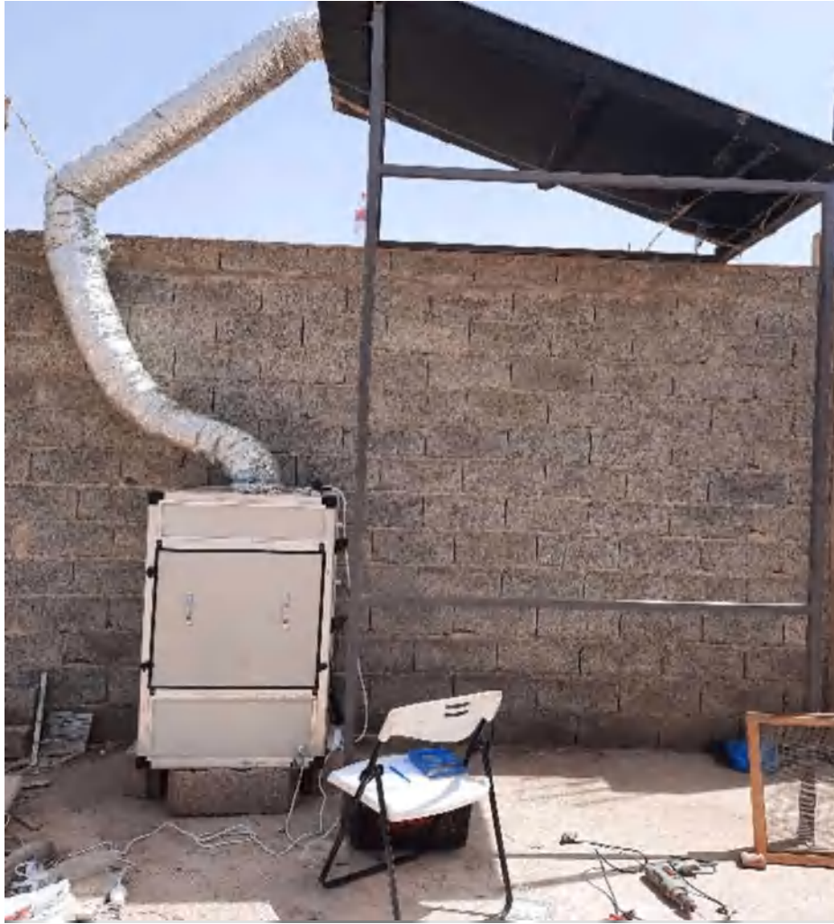
Figure 5.1 : Séchoir Solaire Indirecte réalisé à Constantine.
