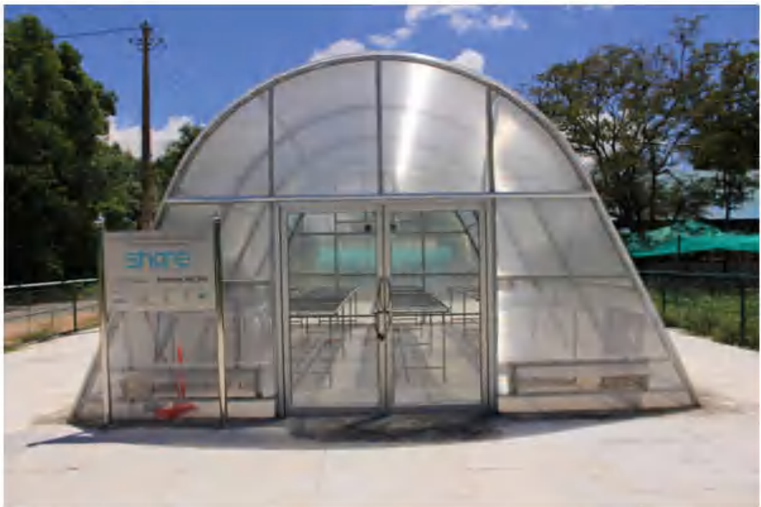
Figure 1.7 : Tunnel de séchage installé à l'université royale d' agriculture de la Cambodia (Banout, 2017).
