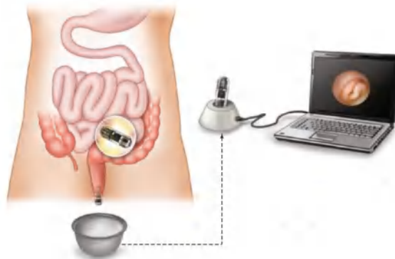
Figure 1. 6 Schéma de la technique de transmission via stockage de données intégrées. [21]
