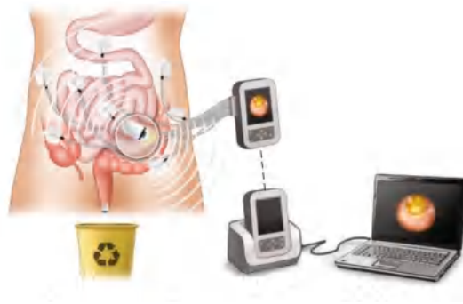
Figure 1. 4 Schéma de la technique de transmission radiofréquence. [21]
