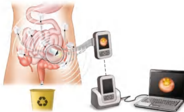
Figure 1. 5 Schéma de la technique de transmission via le corps humain. [21]
