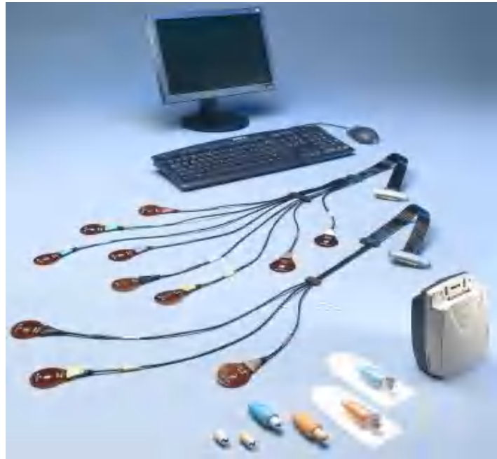
Figure 1. 2 Système de capsule endoscopique : capsule, dispositif d'enregistrement et post de travail. [18]
