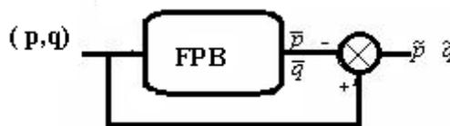
Figure III.4 Schéma de principe d'un filtre passe bas
