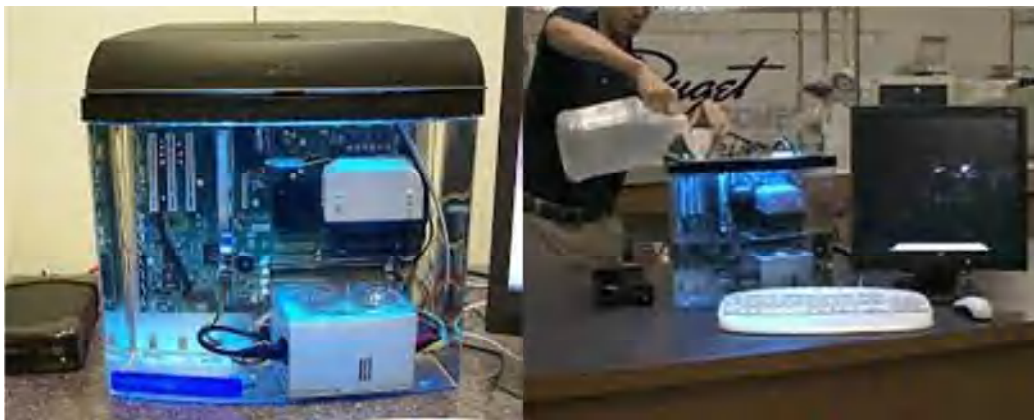
Figure IV.4. Un PC dans un bain d'huile minérale (ordinateur aquarium)
