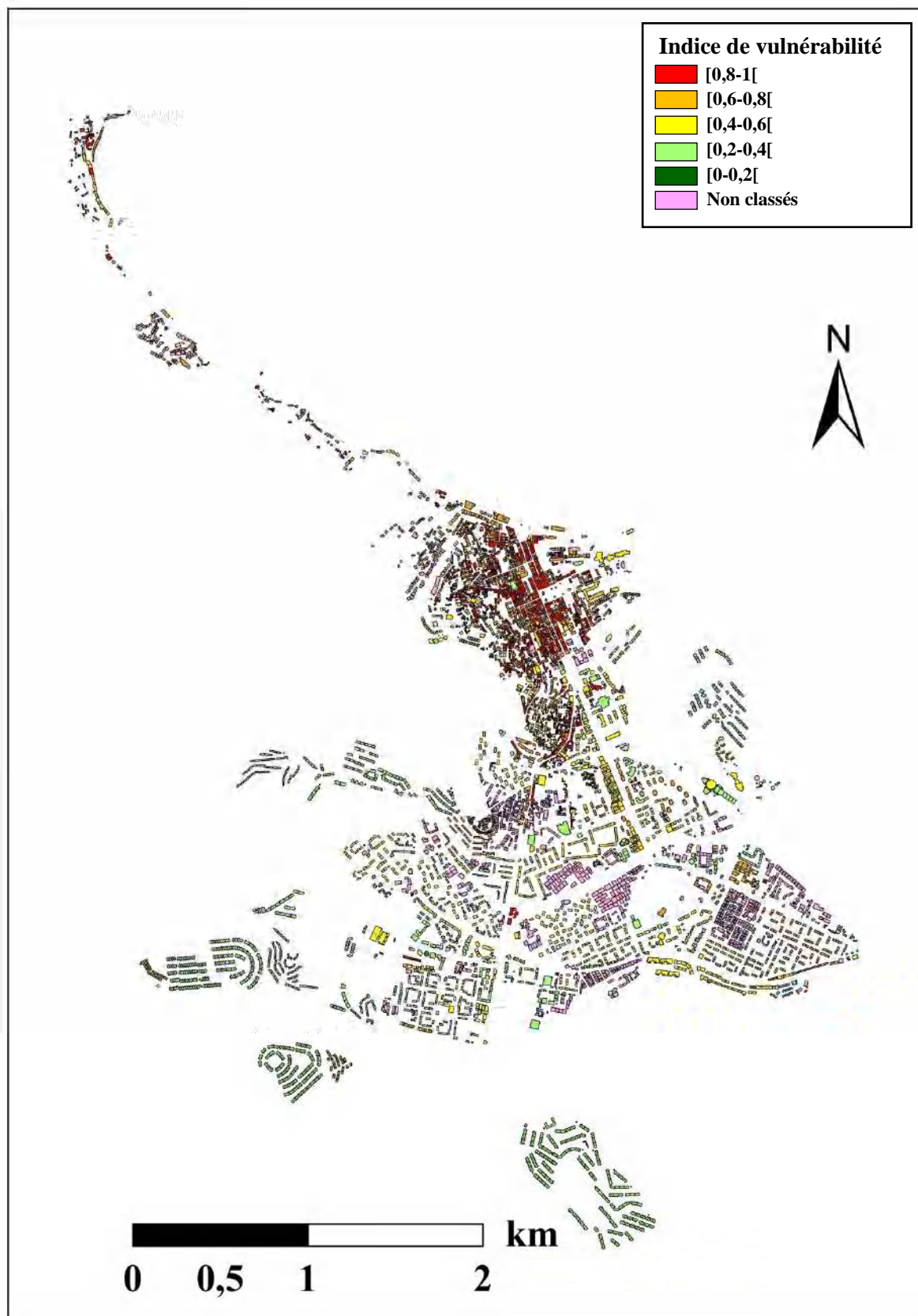
Figure 3.11: Distribution de l'indice de vulnérabilité par bâtiment.
