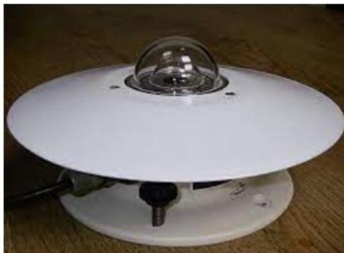
Figure1.5. Le pyranomètre [19].
