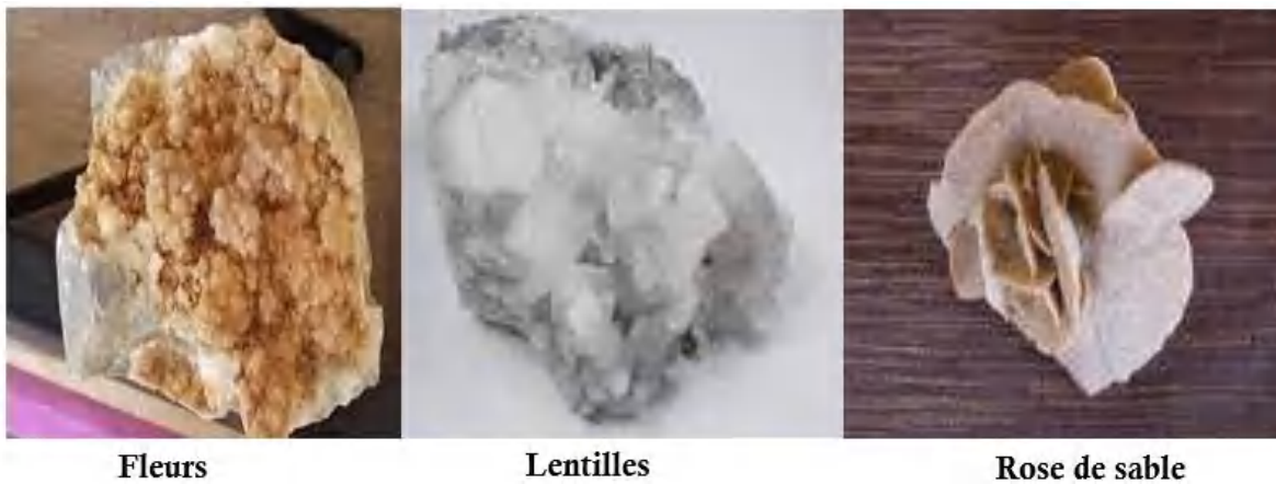
Figure I. 7: Les différentes formes de la vatérite [34].
