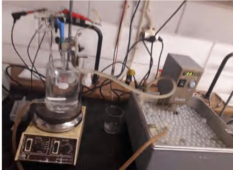
Figure II. 5: Dispositif expérimental utilisé pour les essais d'entartrage accéléré.
