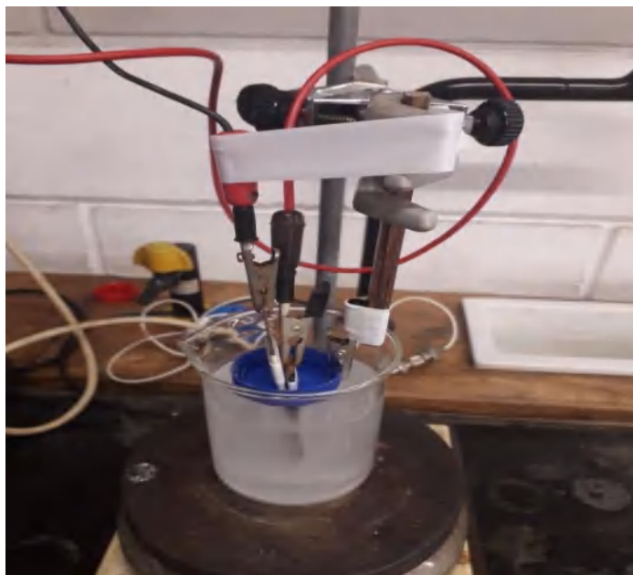
Figure II. 3 : Dispositif expérimental utilisé pour les essais d'oxydation anodique.
