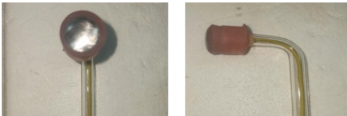
Figure II. 1 : Electrode du travail utilisé.
