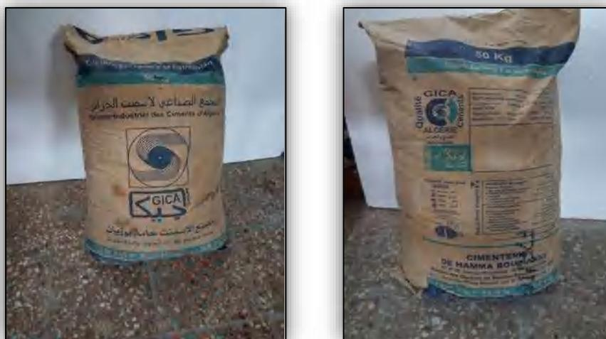
**Figure 4.1** Ciments utilisés CPJ-CEM II/A 42.5.
