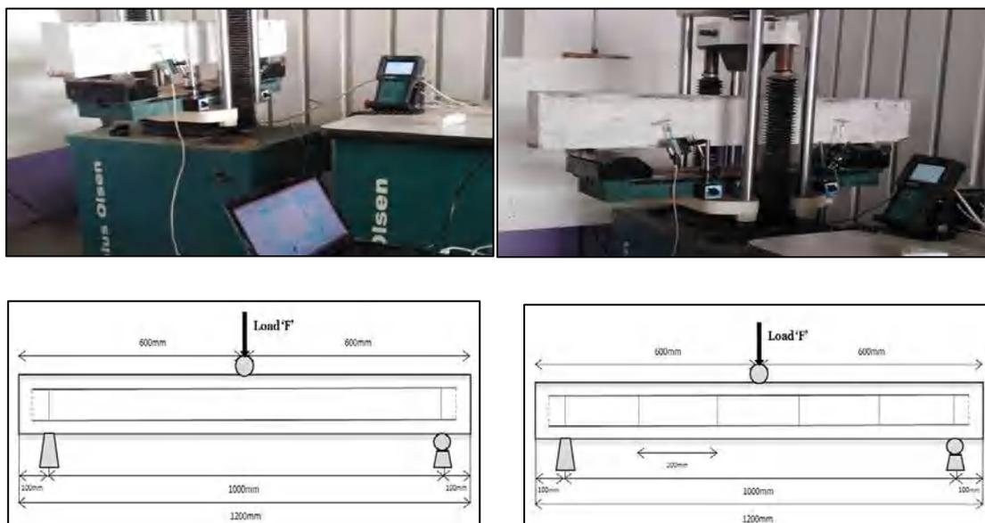
Figure 5.11 .Géométrie des poutres et la configuration du test de flexion à trois points
