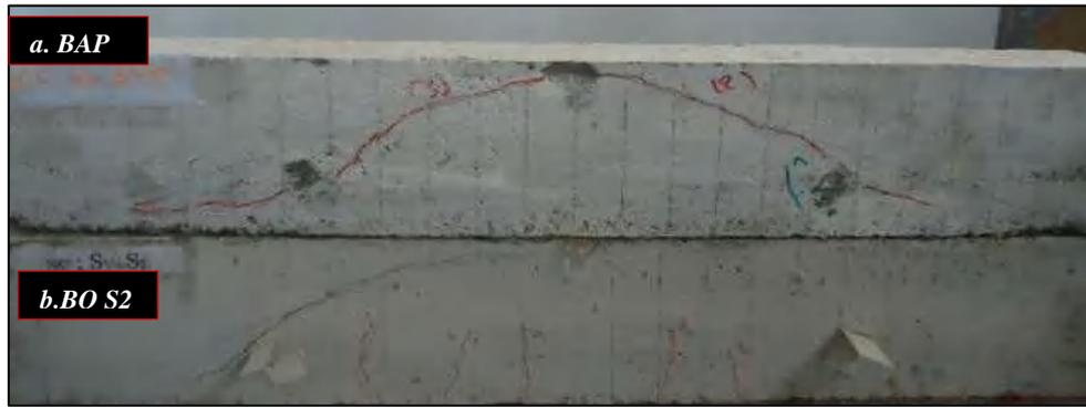
Figure 7.13. Mode de rupture des poutres témoins avec armatures tendues (Série S2) [105].
