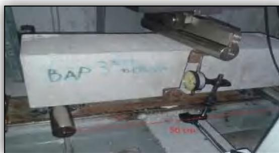
**Figure 4.20.** Dispositif de flexion pour éprouvettes  $7 \times 7 \times 28$  cm
