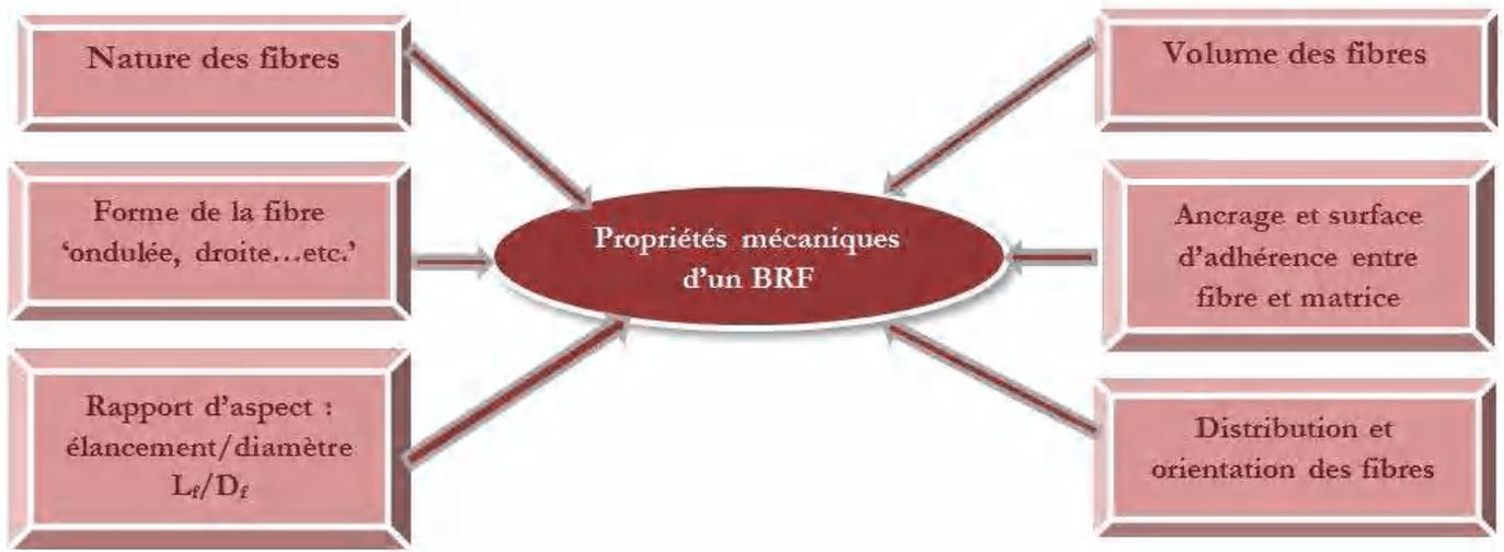
Figure 1.10. Facteurs influant sur le comportement mécanique d'un BRF.
