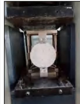
Figure 6.27. Résultats d'essai de traction par fendage des mélanges étudiés
