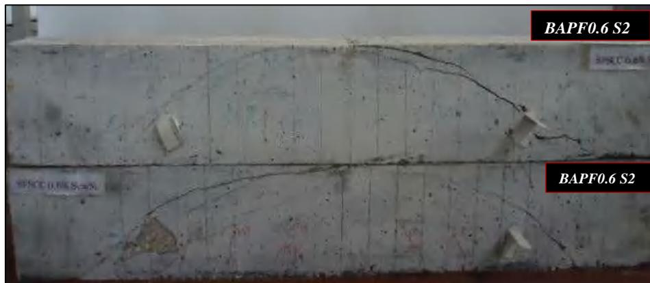
Figure 7.15. Mode de rupture des poutres avec armatures tendues en BAPF0.6% (Série S2) [105].
