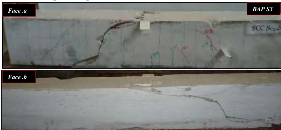
**Figure 7.26.** Mode de rupture de la poutre contrôle BAP S3 avec armatures transversales [105].
