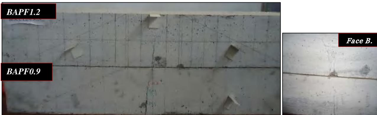
**Figure 7.7.** Mode de rupture des poutres sans armatures en BAPF0.9% et BAPF1.2% (Série S1)
