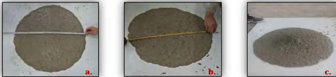
**Figure 6.17.** Résultats d'essai de Cône d'Abram pour respectivement : a. BAP, b.BAPF0.9%, et c. BAPF1.2%.
