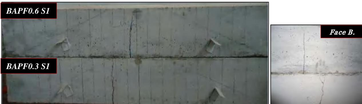
**Figure 7.6.** Mode de rupture des poutres sans armatures en BAPF0.3% et BAPF0.6% (Série S1)
