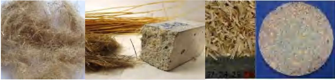
a. Béton à fibre de fibre de lin
