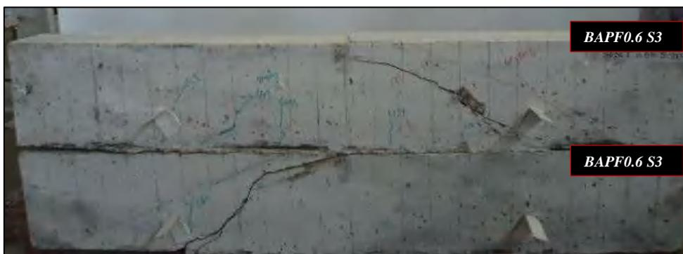
Figure 7.28. Mode de rupture des poutres BAPF 0.6 S3 avec armatures de cisaillement [105].
