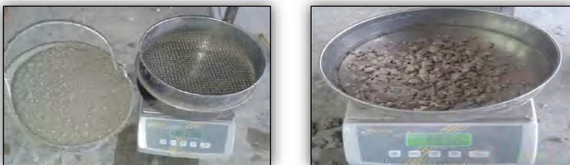
**Figure 4.18.** Essai stabilité au tamis.
