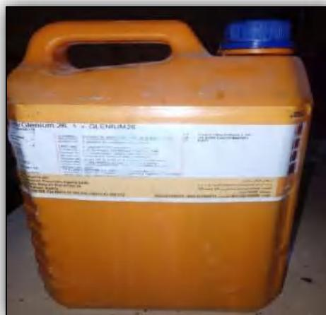
**Figure 4.8.** Fluidifiant « Master-Glenium 26 »
