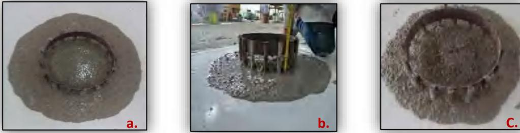
Figure 6.19. Résultats d'essai de J-Ring pour respectivement : BAP BAPF 0.3% ET BAPF 0.9%
