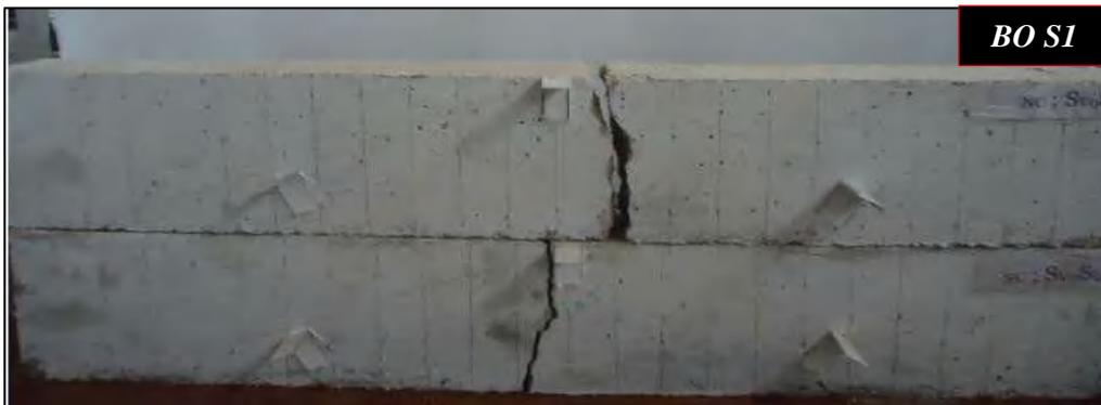
**Figure 7.5.** Mode de rupture des poutres témoins sans armatures (Série S1)
