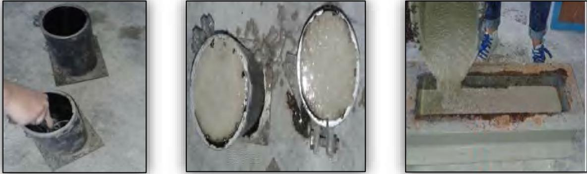
**Figure 4.10.** Lubrification des éprouvettes 10x20 et après leurs remplissage de BAP
