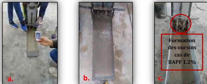
Figure 6.22. Résultats d'essai de « L-box » pour le a. BAP, b. BAPF0.6% et c. BAPF1.2%.
