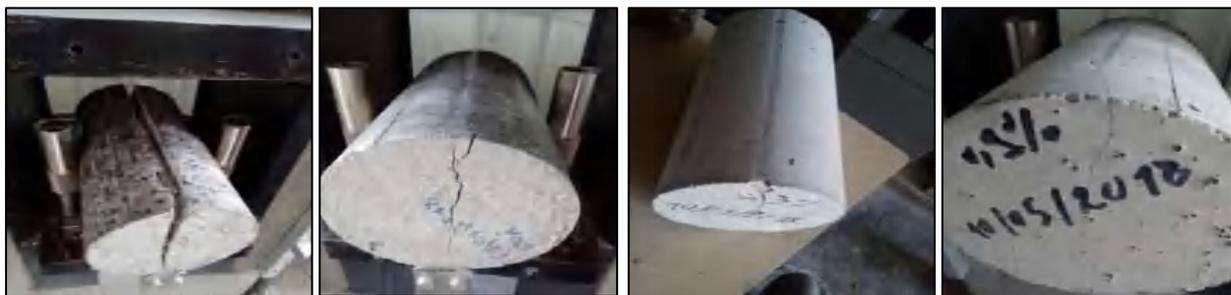
Figure 4.28. Influence du volume des fibres sur le mode de rupture des mélanges étudiés
