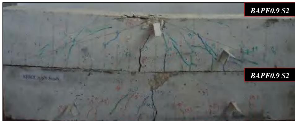
Figure 7.16. Mode de rupture des poutres avec armatures tendues en BAPF0.9% (Série S2) [105].
