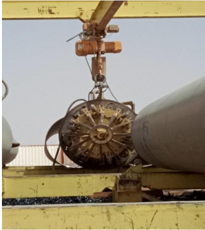
Figure 3- 6:l'opération de chanfreinage pour le soudage automatique et manuel.
