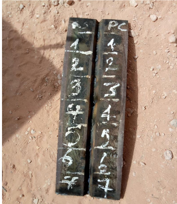
Figure 3- 13:Les deux morceaux prélevés à partir pipelines soudé manuellement.
