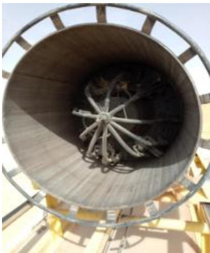
Figure 3- 7:l'opération de Clampsage pour le soudage automatique et manuel.
