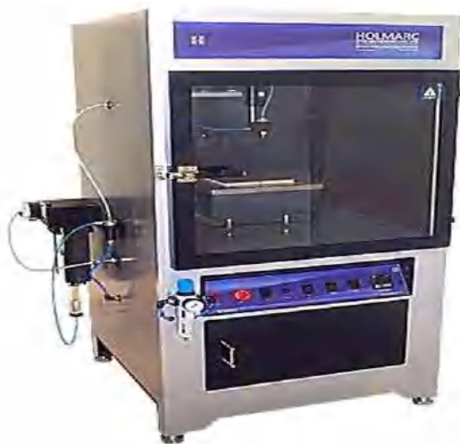
Figure IV.1: Dispositif de dépôt par spray pyrolyse utilisé pour le dépôt des couches minces
