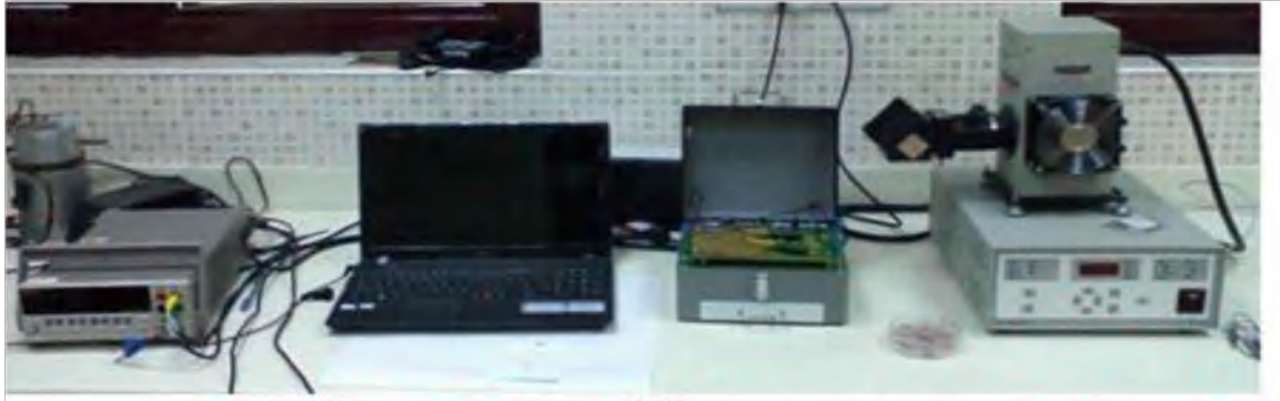
Figure IV. 28: Les dispositifs utilisés pour les mesures (I-V) d'hétérojonctions
