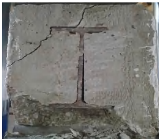
Figure (5.15) :Rupture de la poutre mixte
