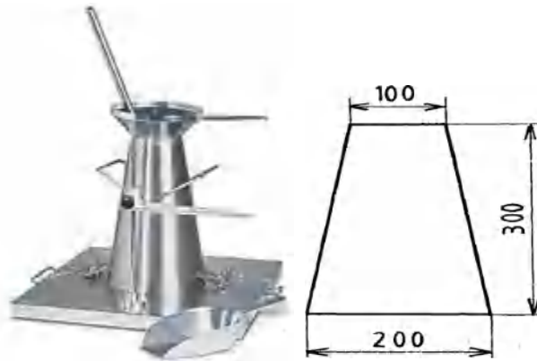
Figure 4.44 : Dispositif et dimensions du cône d'Abrams
