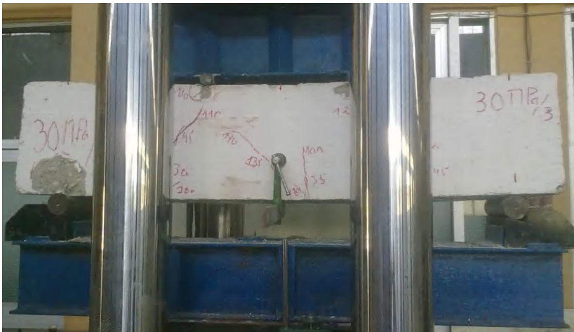
Figure (5.12) :La poutre après la réalisation de l'essai de flexion.
