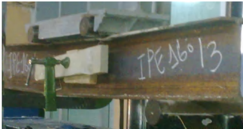
Figure (4.40) : Profilé en IPE après la réalisation des essais.
