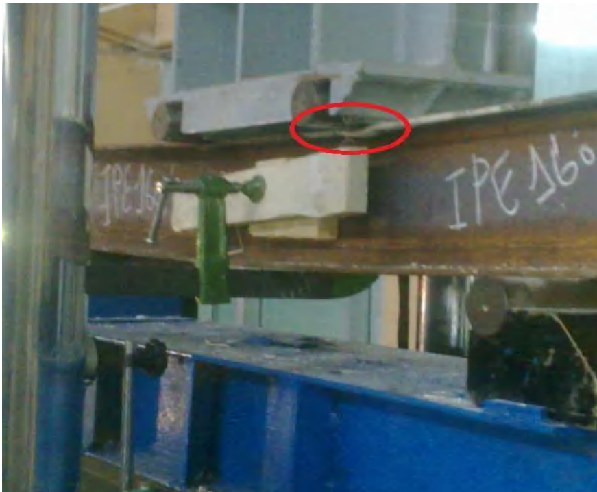
Figure 5.22 : Déformation du point de chargement
