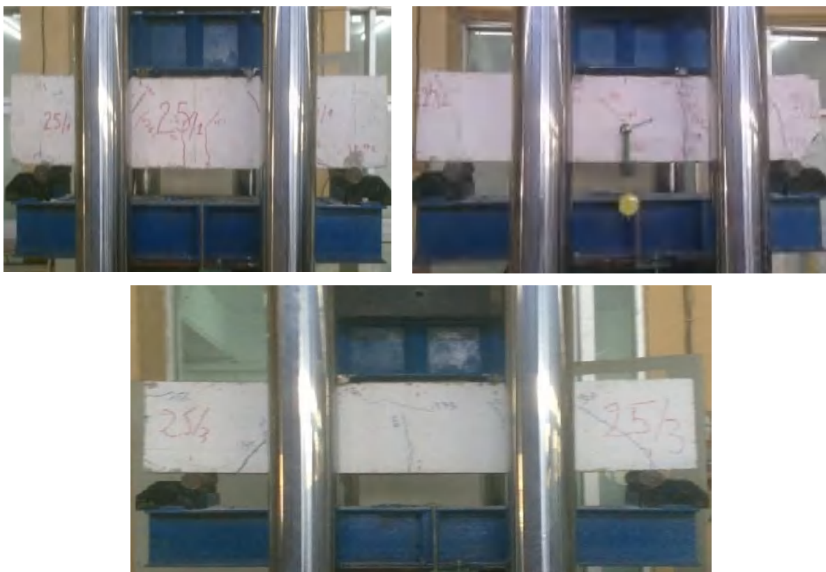
Figure (4-19): Fissuration apparente des poutres mixtes
