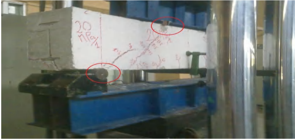
Figure 5.29 : Ruine du béton aux points de chargement
