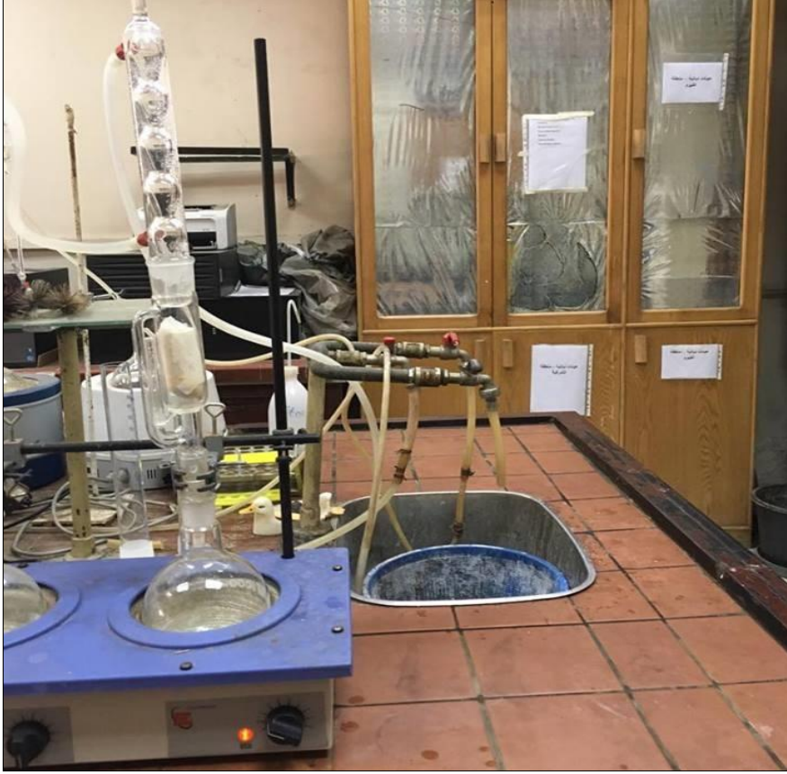
شكل 21 : صورة لجهاز السوكسلت (Soxhlet) المستخدم في عمليتي استخلاص الزيت وتبخير المذيب العضوي لفصل جزئيه المتصبن وغير المتصبن
