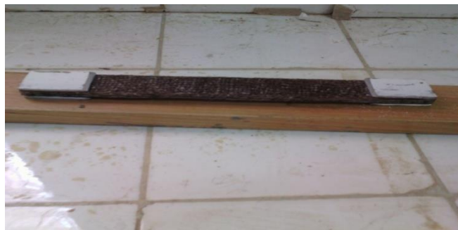
FIGURE 4. éprouvette de traction avec talon
