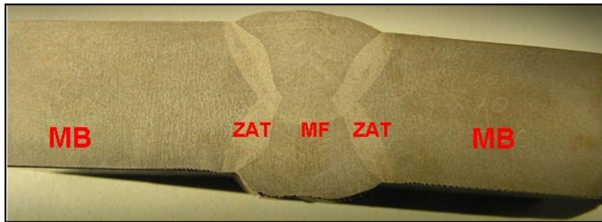
Figure 1: Macrographie du joint soudé
