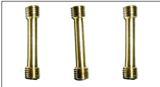
Figure 2: Photos des échantillons Cu-Sn 10 normalisées qui ont servi à l'essai de traction uniaxiale.
