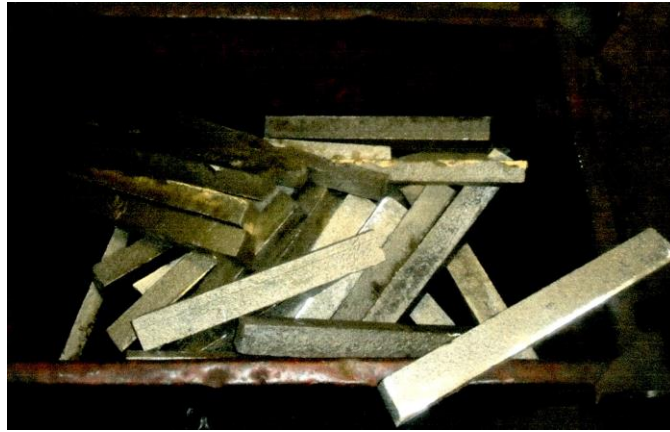
Figure 1: Photos des échantillons Cu-Sn 10 obtenus par le four à remous.
