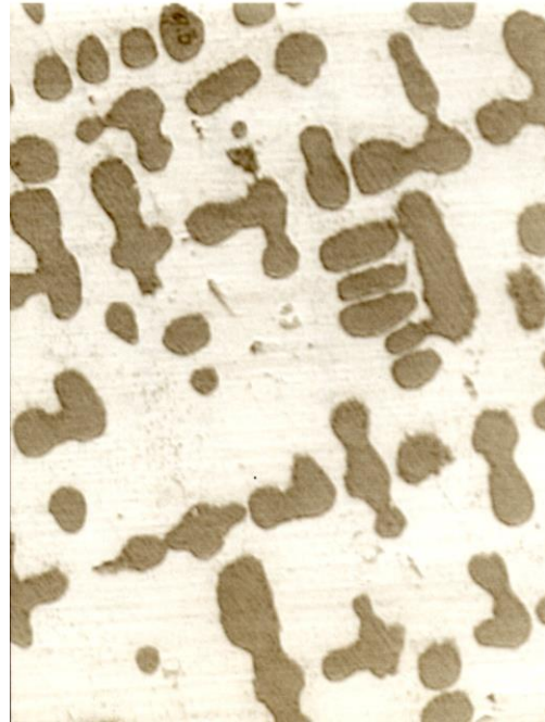
Figure 6: Observation micrographique de l'échantillon 1 après l'attaque chimique (grossissement 300x)
