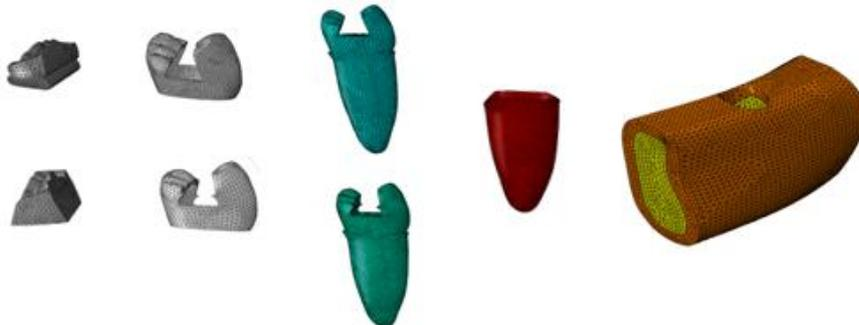
Figure. 5 – Maillage utilisant des éléments linéaires tétraédriques.
