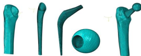
Figure 6 : Maillage typique des composants de la prothèse
