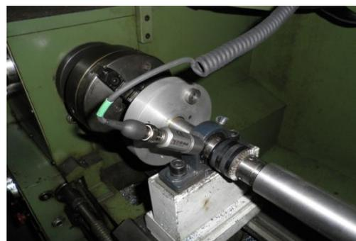
Figure 3 : Capteur piézoélectrique
