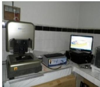
Figure3 : Profil mètre. (ALTISURF500)
