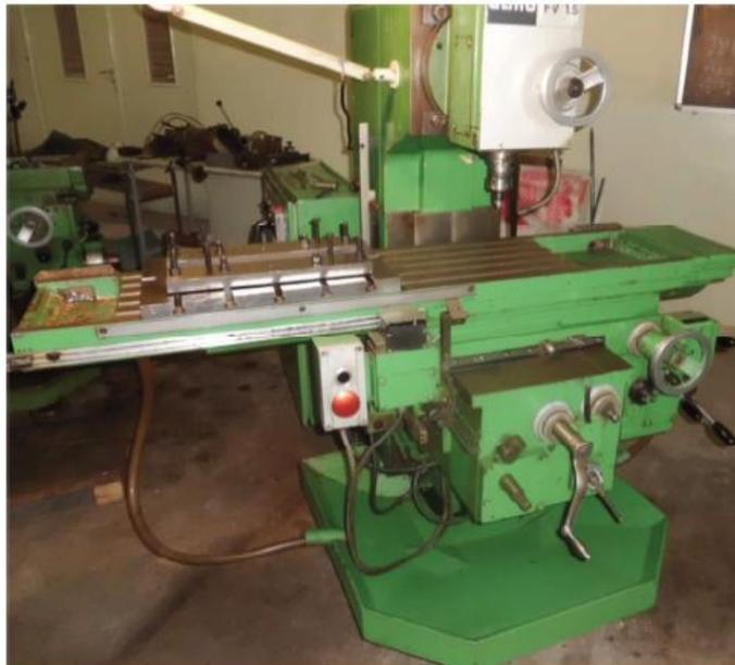
Figure 2 : Machine de fraiseuse utilisée pour le soudage FSW [3].
