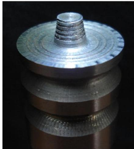
Figure 4 : Outil à pion tronconique fileté utilisé pour le soudage FSW.
