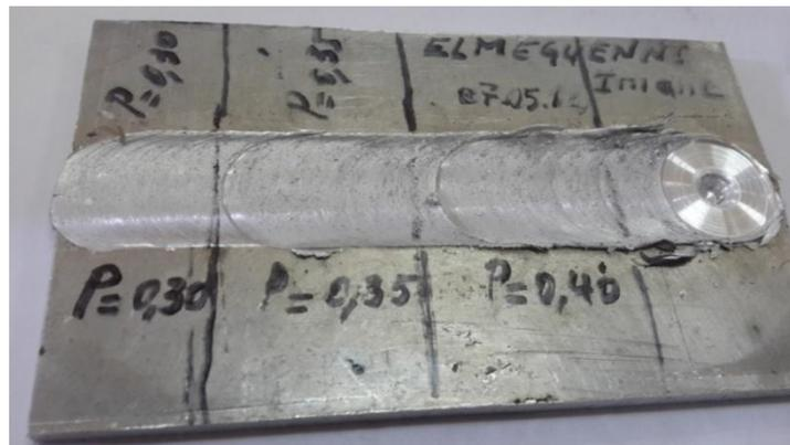
Figure 5 : Soudure obtenue avec les 3 profondeurs (0,30-0,35-0,40).
