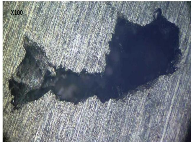
6 : Echantillon d'alliage d'aluminium 5083H111 pour  $P_{\text{épaulement}}=0,25\text{mm}$  (Essai N°4).
