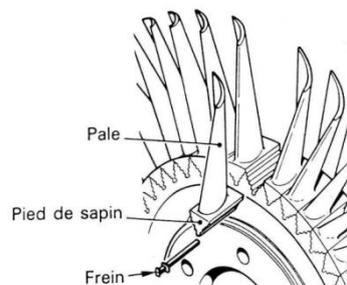
figure 3 fixation des pales
