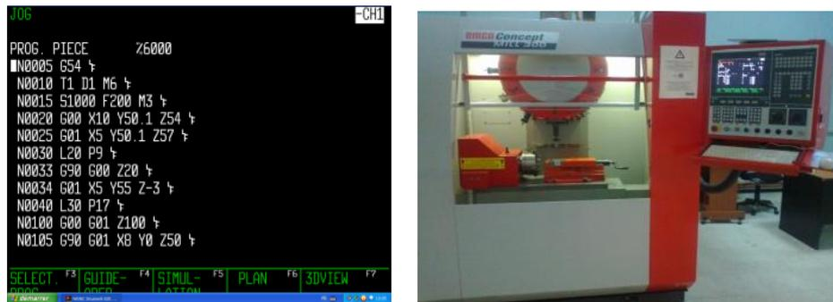
figure 8 . EMCO Concept Mill 300 et programme en code G
