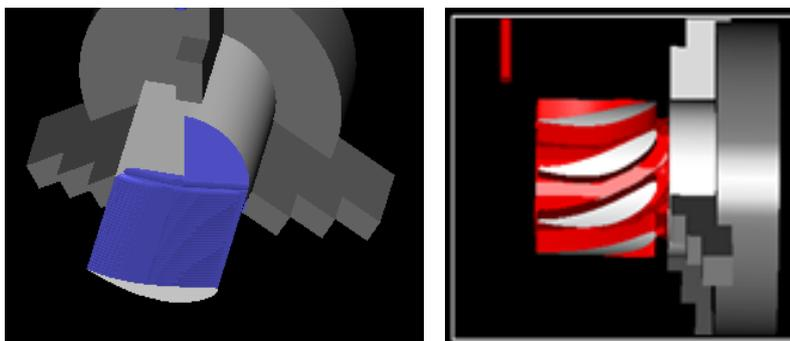
figure 9. Simulation d'usinage des aubes de compresseur
