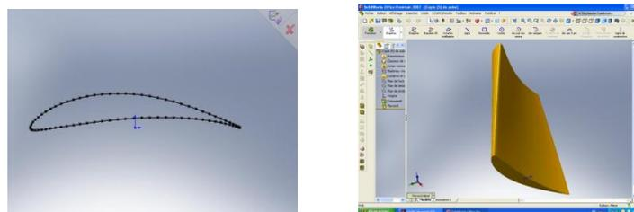
figure 7 . conception de l'aube sous SolidWorks
