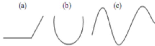
Figure 4 - (a) interpolation linéaire, (b) interpolation circulaire et (c) interpolation polynomiale
