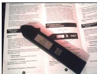
Figure 3 : Photographie du vibromètre
