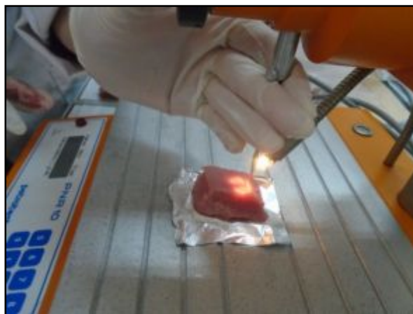
Figure 18 : Image montrant le principe d'utilisation du pénétromètre (PETROTEST PNR10) sur un morceau de viande
