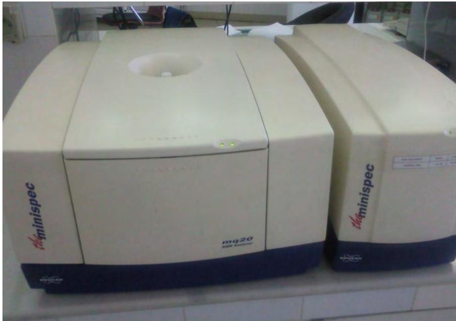
**Figure 30: photo du spectromètre à résonance magnétique nucléaire (RMN) basse résolution type (minispec mq 20, Germany).**
