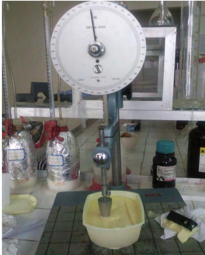
**Figure 33: Pénétrömètre STANHOPE – SETA (Surrey, England) utilisé pour évaluer la consistance ou la dureté des deux formulations de margarine.**
