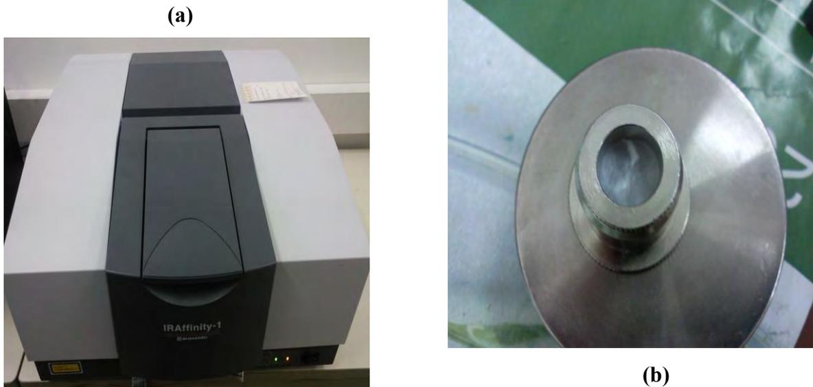
**Figure 29: (a) à gauche ; photo du spectromètre (IR Affinity-1 FTIR SHIMADZU, Kyoto, Japon) utilisé, (b) à droite ; photo de la porte pastille confectionnée à l'aide de la compresse à pastille.**
