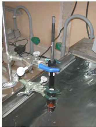
Figure 12 : Système d'extraction par head space statique SPME
