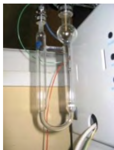
Figure 11 : Système d'extraction dynamique de headspace (DHS) par Purge and Trap
