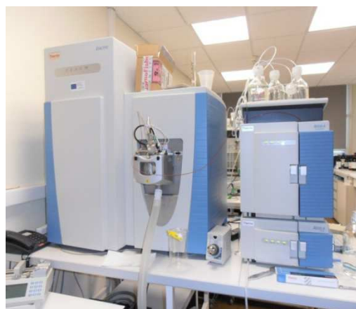
Figure 4. Photo de la chaîne UHPLC de type Accela ((Thermo Fisher Scientific, Bremen, Germany) couplée à un spectromètre de masse Orbitrap (Thermo Fisher Scientific, Bremen, Germany) équipé d'une source d'ion électrospray (ESI).
