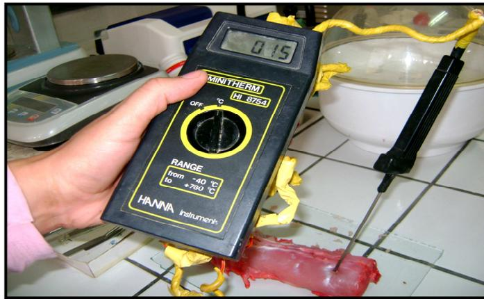
**Figure 23 :** Mesure de la température à l'aide d'un Thermocouple
