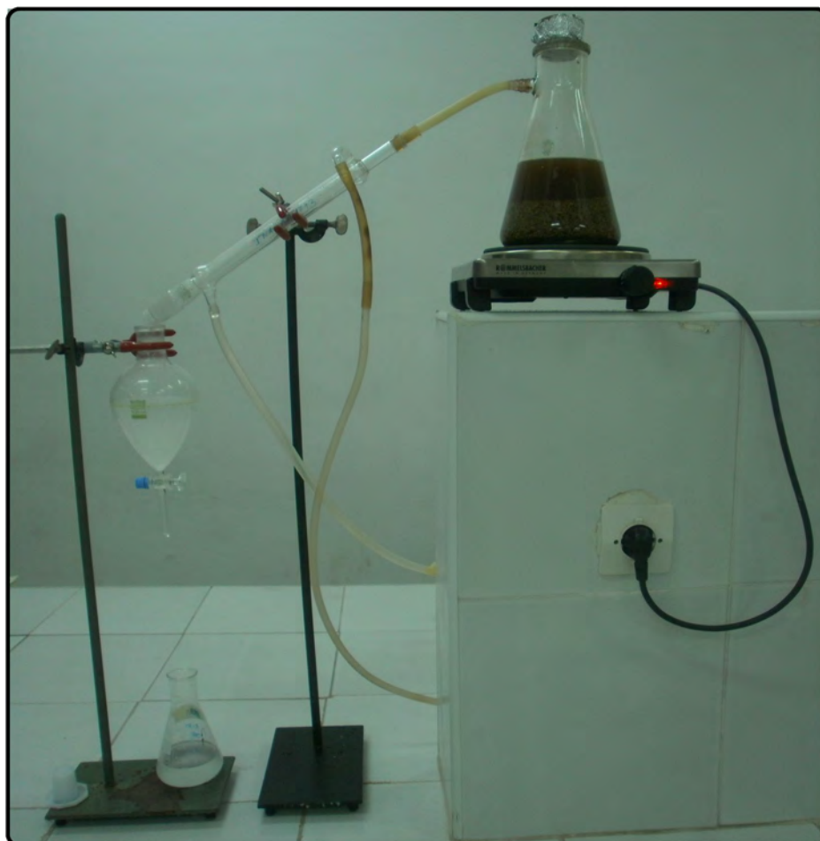
Figure 3. Montage de l'hydrodistillateur
