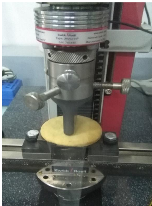
Figure 29. Test de flexion en trois points par texturomètre Zwick
